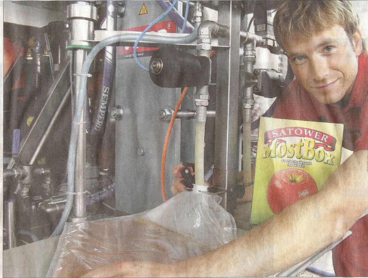
Benjamin Peters beim Abfüllen des Saftes aus der mobilen Mosterei: aus 100 Kilo Äpfeln lassen sich in gut 15 Minuten 70 Liter Saft produzieren. (l.) Schon in der Bandpresse lässt sich ein Schluck Saft (Foto unten) probieren. Fotos: Dorit Wehmeier
